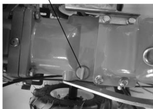
Sl. 5 –Proveravanje nivoa ulja u menjaču
