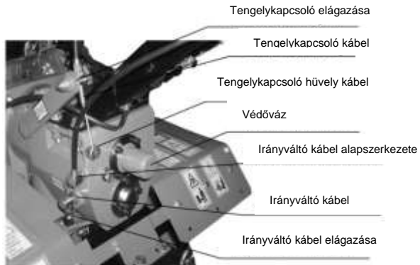
6. Ábra – Tengelykapcsoló kar felszerelése és beállítása
