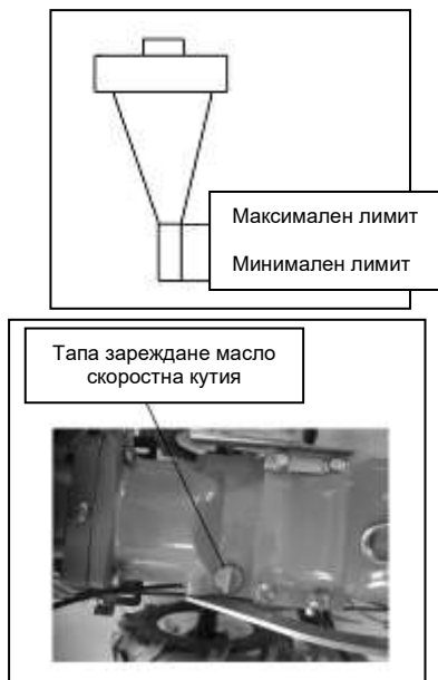
Фиг. 5 – Проверка на нивото на трансмисионното масло
