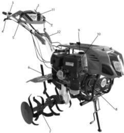
1. Ábra – A motoros kapálógép általános kinézete
