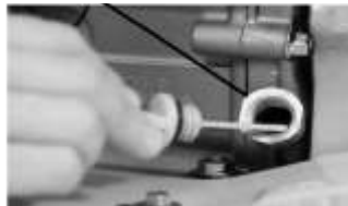
5a. Ábra – Motorolajsztint ellenőrzése
